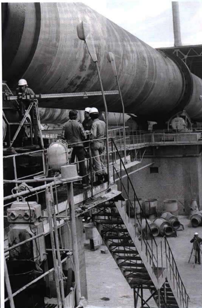
Powyżej: Osiowanie pieca obrotowego Na stronie obok: Szef Hindusów inż. Sasturkar podczas pomiarów
